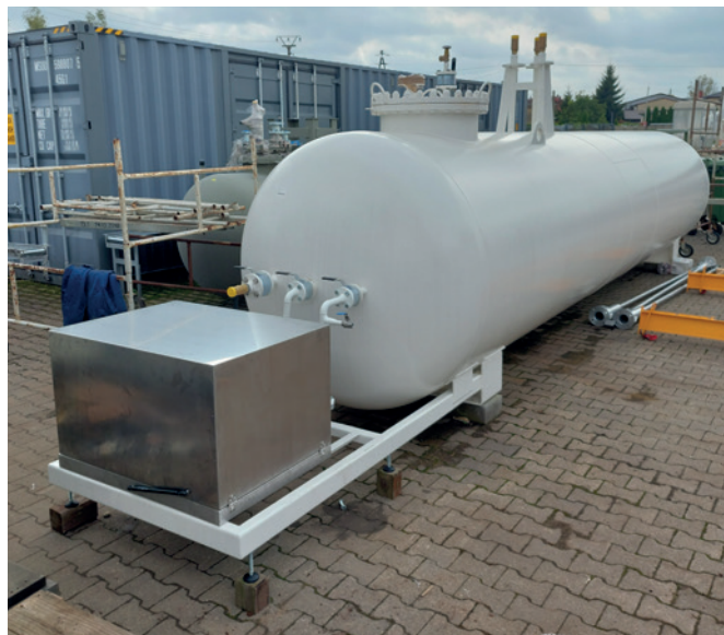
Proyecto módulo GLP Letonia: 15 m 3 , diámetro 1600 mm
