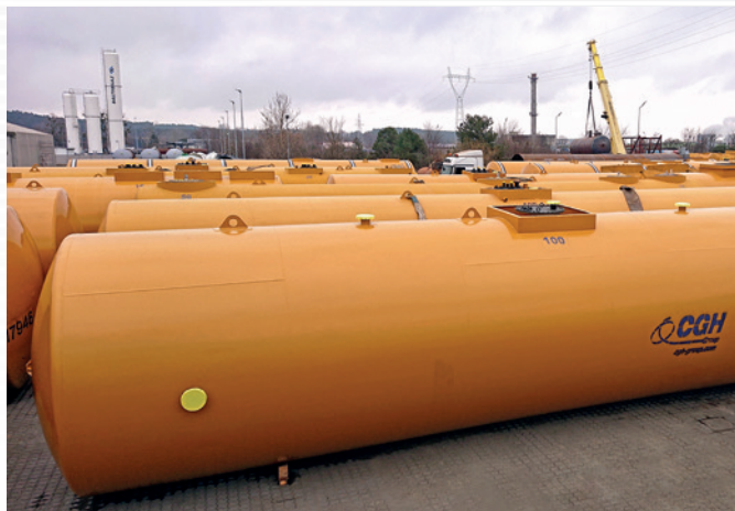
Zbiornik magazynowy wody podziemny
