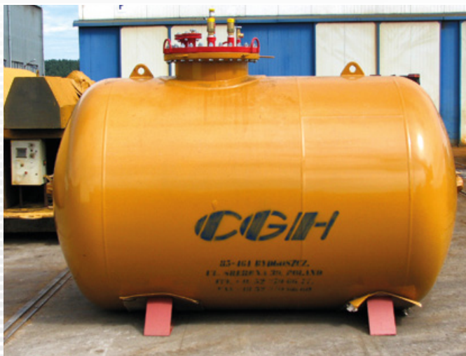
Projekt Stacja LPG: 10 m 3 , Ø 2000 mm
